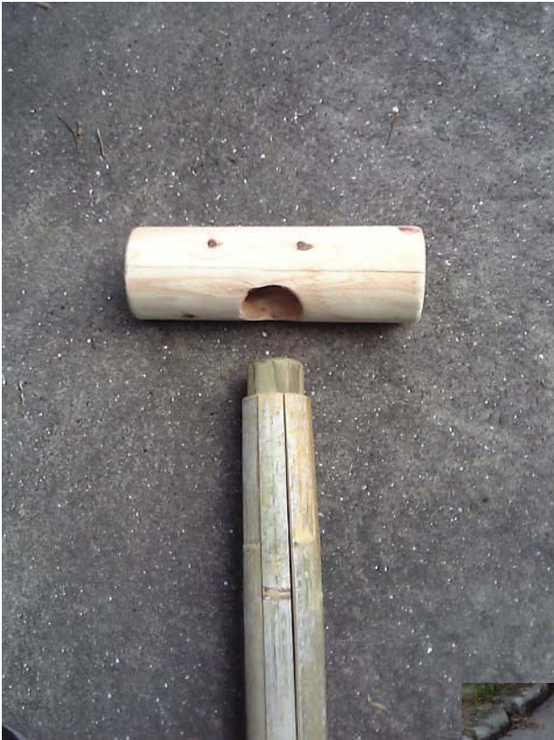
T型継手接続前
